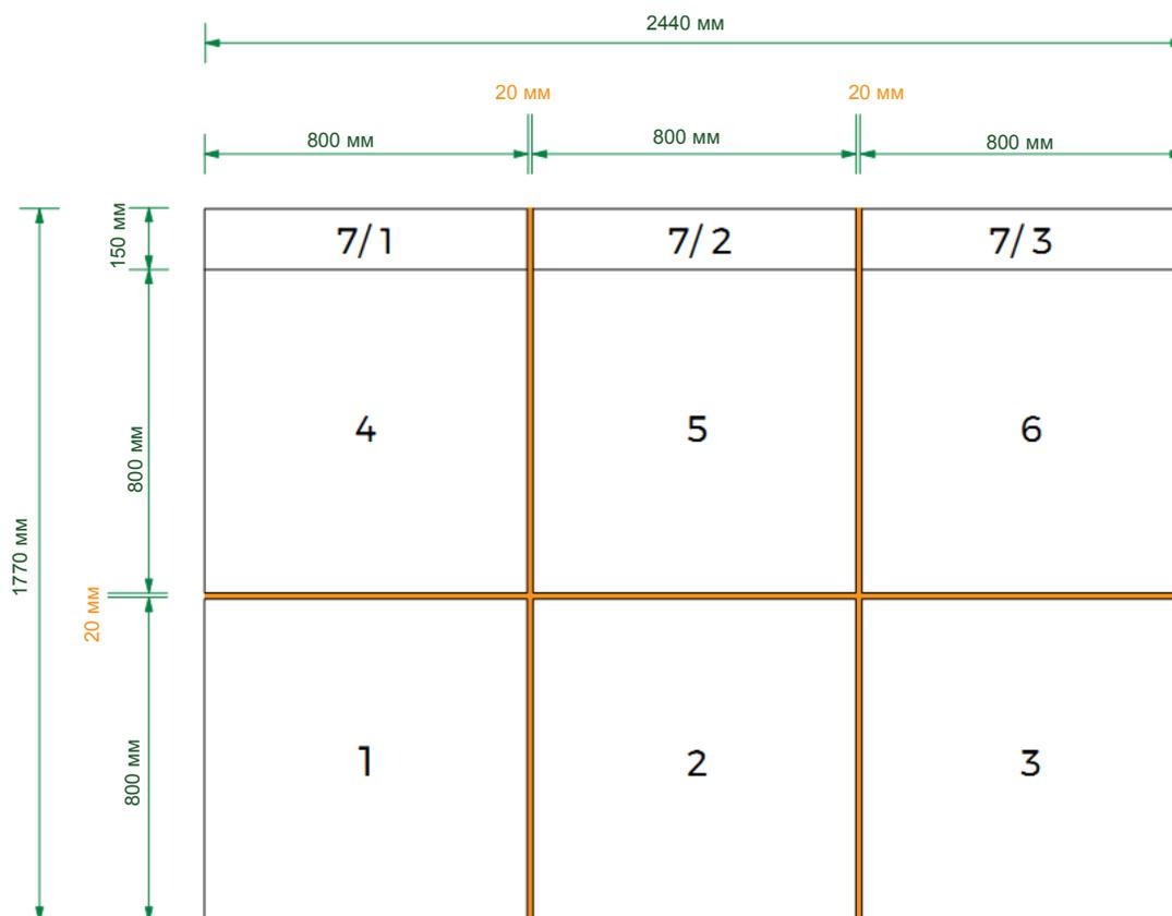
**ПРИМЕЧАНИЕ.** Листва на панелях позволяет увеличить зазор еще на 20 мм, прежде чем стыки станут заметными. Располагая панели чуть дальше друг от друга, мы можем полностью покрыть необходимую площадь без использования дополнительных панелей.
